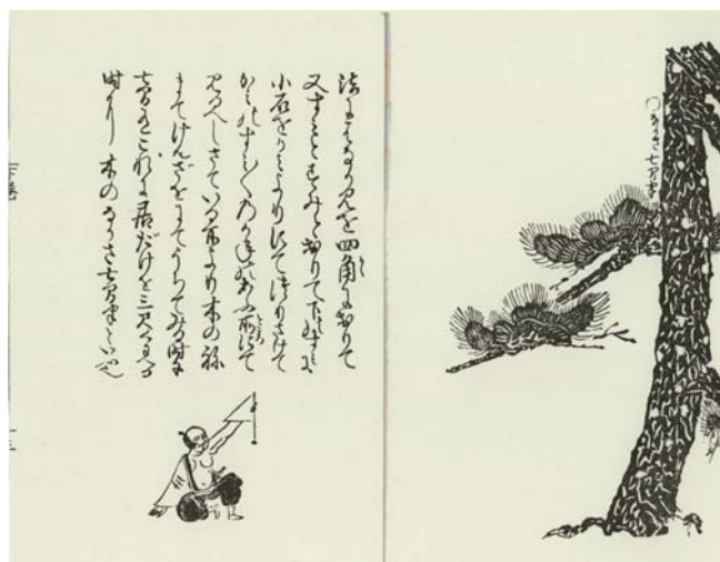
図12 相似比を使って木の高さを簡単に測る方法
