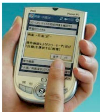
①②音声でコミュニケーションができない人のための音声出力装置。①重量 275 g : キーの数を 1、2、4、8、16 個と変更でき、各キーに最長 2 分までメッセージを録音できる。②重量 900 g : ひらがな 50 音配列のキーを持ち、入力した文字を読み上げてくれる。③音声でも文字でもコミュニケーションできない人のための指点字式通信端末。両手に端末機を持ちキーを指で押すと、信号を受信した相手の端末機の同じキーが連動して動く装置。④ポケット PC をベースにした高次脳機能障害者向けの就労支援システム。作業の手順の確認は、文字や画像、音声を利用してでき、また、スケジュール管理は時刻の表示だけでなく、視覚的にわかるようにバーを使って残り時間を知らせることができる。
